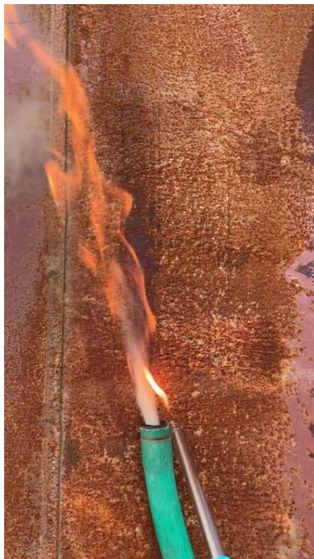
სურ1. ლაბორატორიულ გეორეაქტორში ნახშირის გაზიფიკაციის შედეგად მიღებული სინთეზური გაზის აალების და წვის პროცესი
