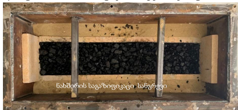
სურ. 2. გეორექტორში ფორმირებული ნახშირის საგაზიფიკაციო სანგრევი
