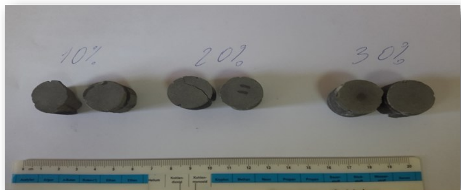
აფეთქების ტექნოლოგიის გამოყენებით დაწნეხილი ალუმინის ფხვნილის სხვადასხვა პროცენტული რაოდენობის შემცველი ნიმუშები.
