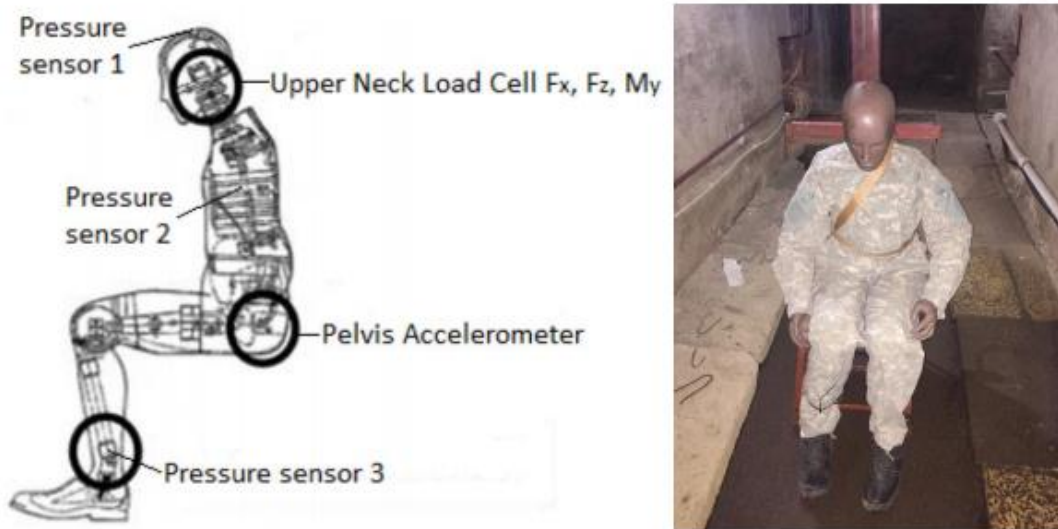
სურ. 1. ადამიანის ანტრომორფული მოდელი Hybrid III 50th და სენსორების განლაგების სქემა
