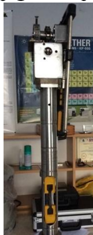
სურ. 4. ხანგამძლეობაზე და ცოცვადობაზე გამოსაცდელი მოწყობილობა
